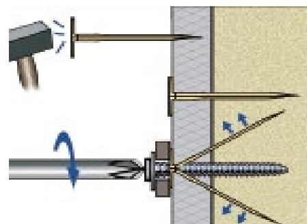
Gipsplaat tot 13mm , Vezelgipsplaat, fibro-cement , Geperste houtvezelplaat 3 tot 5mm
